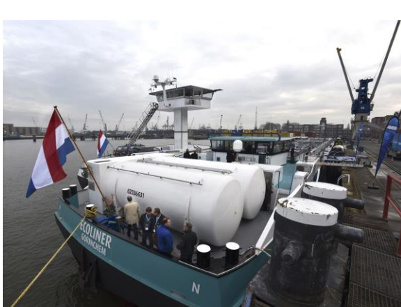
74. ábra Deck feletti tartály elhelyezés
